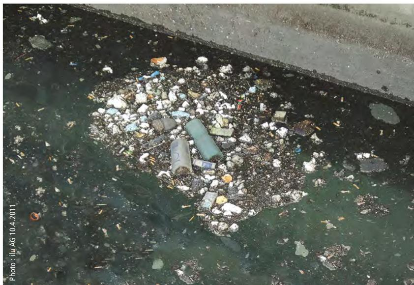
▲ Figure 2: Des micro et macro-plastiques sont également transportés avec les eaux de chaussée. La photo montre des déchets plastiques retenus dans le bassin de décantation du système d'évacuation et de traitement des eaux de chaussée (SETEC) de Chlosterschür.
